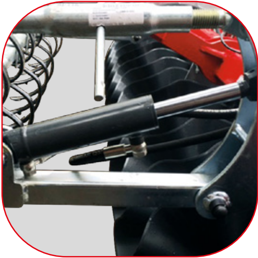
Hydrauliczna regulacja głębokości pracy lub kąta przedniej listwy doprawiającej
