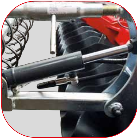
Hydrauliczna regulacja głębokości pracy lub kąta przedniej listwy doprawiającej / Hydraulic adjustment of the working depth or the angle of the front fixing strip/ Hydraulische Regulierung der Arbeitstiefe oder des Winkels der vorderen Anreicherungs-Leiste
